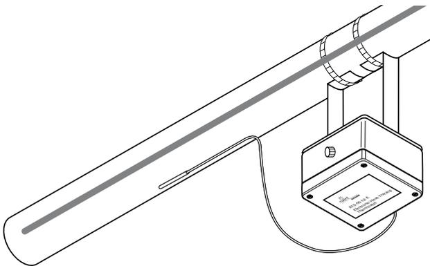
RAYCHEM ETS-05 表面感应和环境感应电子式温控器能够为伴热线提供准确的温度控制。
