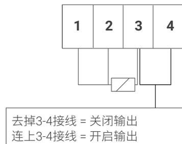
接线端子1至3可用于连接3线PT100传感器。
