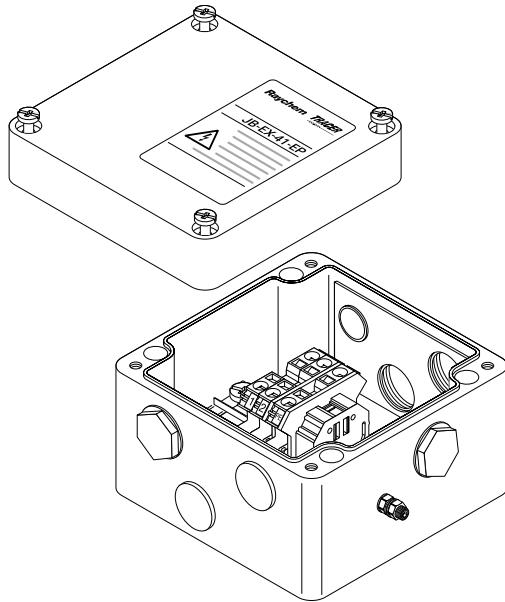
JB-EX-41-EP是带接地板的工业聚酯接线盒，用于危险区域。该接线盒使用M25金属连接套件或格兰能够连接电力电缆、伴热线和冷端线，通过接地板实现连接接地。
