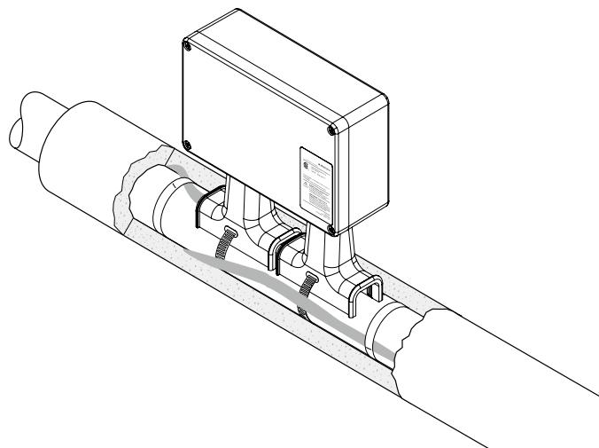
Raychem JB-SPLICE-PI-E套件设计用于将Raychem XPI工业串联电阻式伴热线进行两通连接，无需使用冷端线，并且具有一定的功率和电流限制。
